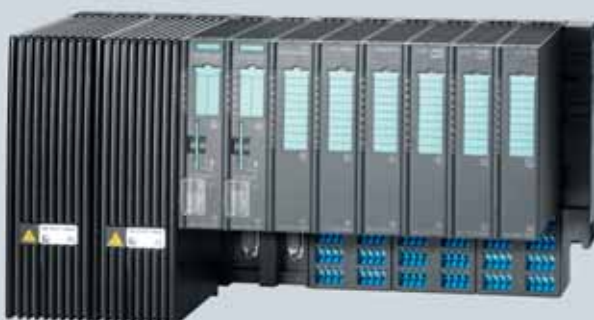
Redundancja zasilania (dwa zasilacze) i komunikacji (dwa interfejsy komunikacyjne)
