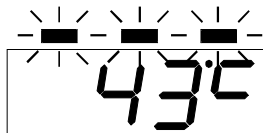
Rys. 35. Sygnalizacja pracy regulatora w trybie awaryjnym.
