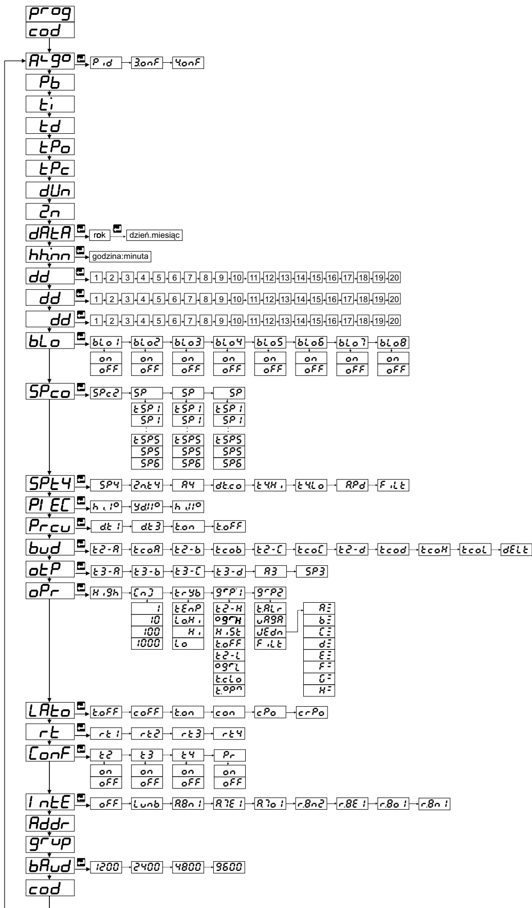
Rys. 16. Algorytm programowania parametrów regulatora.
