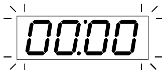
Rys. 34. Sygnalizacja braku aktualnych danych zegara i kalendarza.
