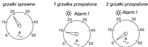
Rys.56. Alarm przepalenia grzałki.
