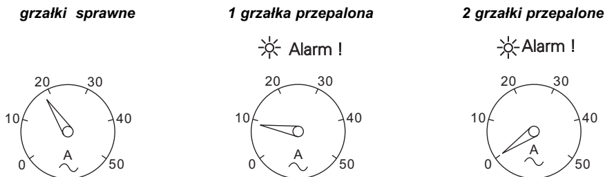
Rys.56. Alarm przepalenia grzałki.
