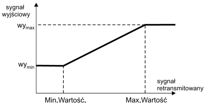
Rys. 18. Przeliczenie sygnału do retransmisji
